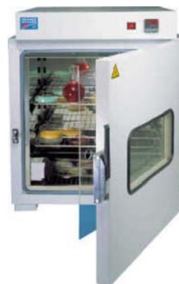
法国 ETUVES 公司生产的系列培养箱，具有高的通用性和集成性，广泛地应用于生物学、医学、药学、卫生防疫和工业的微生物检测实验室，以及作为标准的设备用于微生物的培养过程、质量控制、回火和热储存等，其具有两种设计供选择，分别为空气层流式和风扇强制对流式，以保证控温的准确度和降低温度的偏离。
