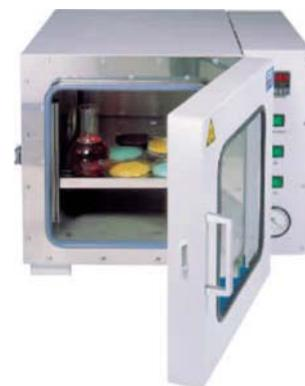
□ **加热:** 箱内的加热采用大面积的加热元件外表面包覆。采用无磨损开关(固态继电器)控制加热元件。也可选择内部加热板, 安装在箱内代替外部加热器。
