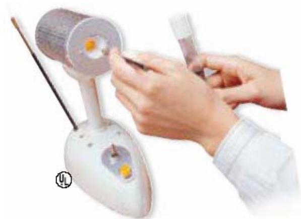
用火焰消毒是古典的微生物学方法，由于会产生气溶胶，并使生物安全柜内气流紊乱，尽量不要在生物安全柜内使用。在使用火焰消毒法时，建议使用电子式灭菌器。Bacti-Cinerator\* VI型电子灭菌器采用红外线热能灭菌，因其使用方便、操作简单普遍使用于微生物实验室。
