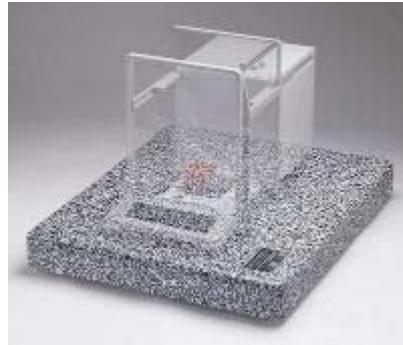
Vibrasorb®天平防震垫(天平振动阻尼支座)，安装的目的是为了优化天平的使用条件，防止天平因暴露在震动环境中而引起的机电部件的过度磨损和设备结构的损伤。甚至可以通过接触引起的振动，其采用浓密的黑色和白色的水磨石成型，6.4cm(2吋)厚的平台，四个 Vibro-Absorber™氯丁橡胶脚垫和承载到 16kg (35 磅)。
